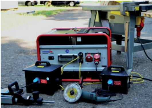
Anschlussbeispiel von drei Betriebsmitteln an einen Stromerzeuger, Säge direkt angeschlossen, Abbruchhammer und Trennschleifmaschine werden bei „erhöhter elektrischer Gefährdung“ jeweils über einen Trenntransformator betrieben
