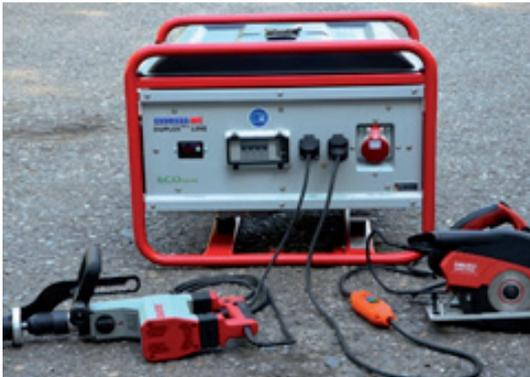
Anschlussbeispiel von zwei Betriebsmitteln an einen Stromerzeuger, Abbruchhammer direkt angeschlossen, Handkreissäge über einen PRCD betrieben.
