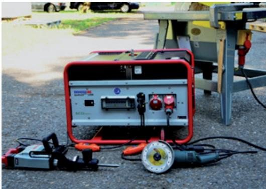
Anschlussbeispiel von drei Betriebsmitteln an einen Stromerzeuger, Baustellenkreissäge direkt angeschlossen, Abbruchhammer und Trennschleifmaschine über je einen PRCD betrieben
