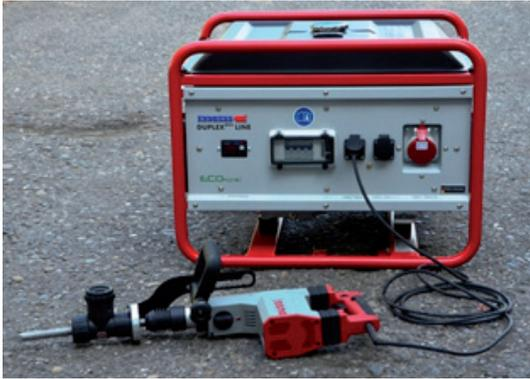
Beispiel für einen Stromerzeuger der Ausführung A mit drei Steckdosen und nur einem angeschlossenen Betriebsmittel, zusätzliche Schutzmaßnahmen sind nicht erforderlich
