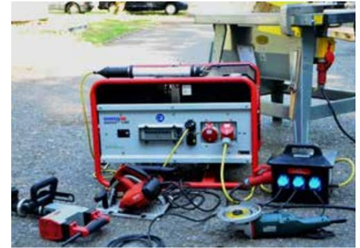
Anschlussbeispiel von fünf Betriebsmitteln an einen Stromerzeuger, Handleuchte direkt angeschlossen, alle anderen Betriebsmittel über Verteilerbox mit RCDs betrieben
