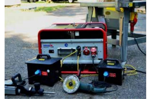
Anschlussbeispiel von drei Betriebsmitteln an einen Stromerzeuger, Säge direkt angeschlossen, Abbruchhammer und Trennschleifmaschine werden bei „erhöhter elektrischer Gefährdung“ jeweils über einen Trenntransformator betrieben
