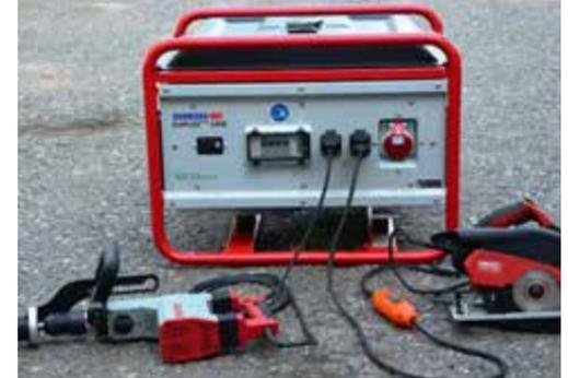
Anschlussbeispiel von zwei Betriebsmitteln an einen Stromerzeuger, Abbruchhammer direkt angeschlossen, Handkreissäge über einen PRCD betrieben.
