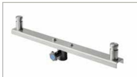
**Doppel-Traverse zur Aufnahme von 2 Strahlern**, bestehend aus Edelstahl U-Eisen 450 mm bzw. 600 mm Länge, Basishalter zum Anbau auf einen DIN-Zapfen Ø = 30 mm, inklusive Sterngriff M8 zur Befestigung am Stativ mit 2 Edelstahl DIN-Zapfen Ø = 30 mm, Mittenabstand der Zapfen ca. 400 mm bzw. 550 mm
