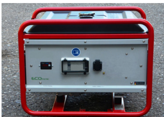
Stromerzeuger nach Ausführung „A“ mit nur einer Steckdose zum direkten Anschluss von nur einem Betriebsmittel, zusätzliche Schutzmaßnahmen sind nicht erforderlich
