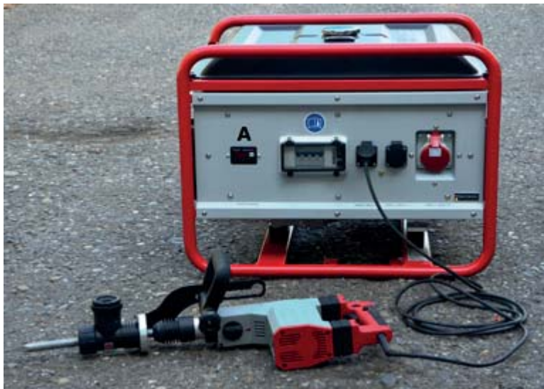
Abb. 20 Ein Betriebsmittel angeschlossen ohne weitere Schutzmaßnahme
