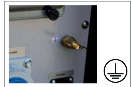
Abb. 2 Symbol 5019 „Schutzerdung“ nach DIN IEC 60417
