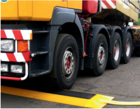
Abb. 5 Kabelbrücke aus hoch belastbarem Material
