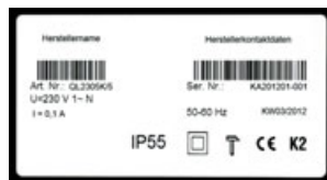
Abb. 16 Typschild einer Hand- leuchte mit notwendigen Angaben
