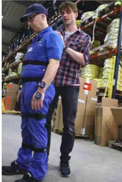
Abb. 2: Anbringung der EMG- und Inertialsensoren am Arbeiter
