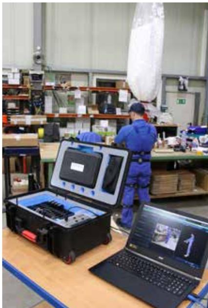
Abb. 1: Arbeitsplatzanalyse mit Hilfe eines speziellen biomechanischen Messsystems
