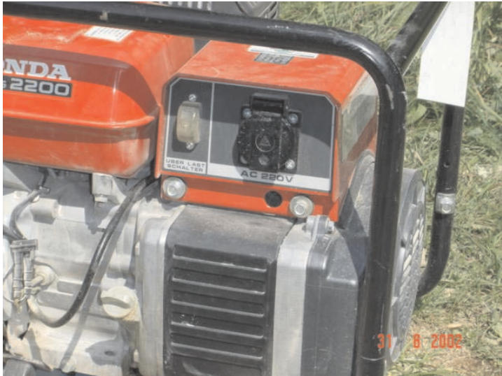
Abb. 7: Ersatzstromerzeuger kleiner Leistung zum Anschluss nur eines Verbrauchsmittels
